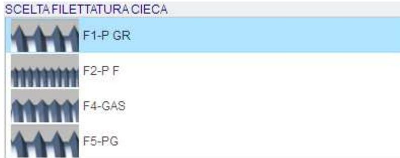
Il programma legge automaticamente i files utente definiti con Creo ma in un apposito direttorio si deve configurare l'icona da visualizzare e alcuni parametri che permettono di visualizzare il passo nei fori filettati con passo fine o informazioni aggiuntive per i GAS e PG.
